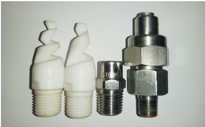
Figure 2. Tested nozzles (from left: TF 6 FCN, TF 6 V, NF 15, CW 50) Rycina 2. Dysze poddane badaniu (od lewej: TF 6 FCN, TF 6 V, NF 15, CW 50)
