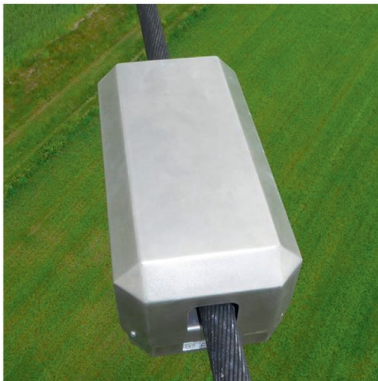
Fot. 1. Zdjęcie rejestratora badawczego na przewodzie linii 400 kV [9]
