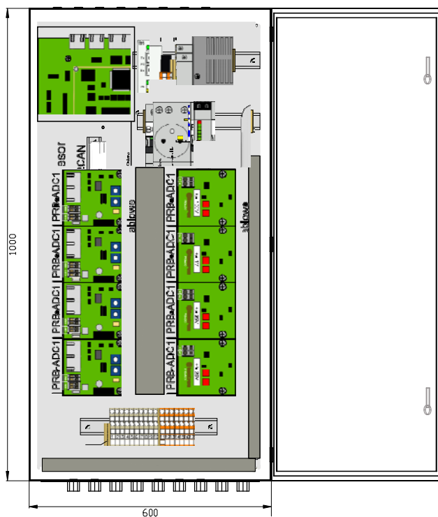
Rys. 5. Płyta czołowa w obrysie szafki pomiarowej stosowanej na II linii metra
