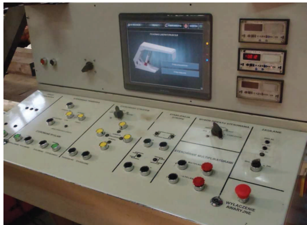
Rys.4. Pulpit sterowniczy stanowiska do badań funkcjonalności i kinematyki sekcji obudowy zmechanizowanej [1]
