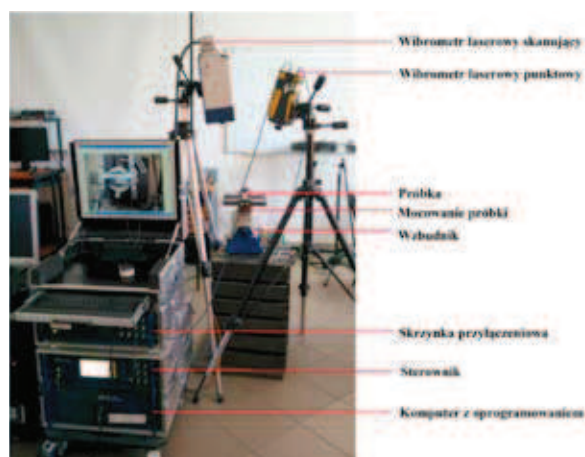
Rys. 9. Stanowisko badawcze do analizy modalnej
