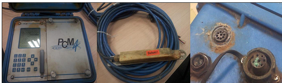
Rys. 4. Wyeksploatowany przepływomierz ultradźwiękowy [MPWiK S.A. we Wrocławiu]
