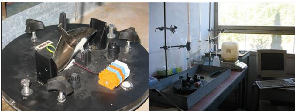
Rys. 3. Kalibracja deszczomierza [E. Burszta-Adamiak]
