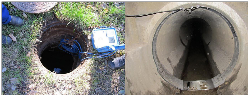
Rys. 1. Przepływomierz ultradźwiękowy: jednostka pomiarowa (po lewej), górna i dolna sonda (po prawej) [MPWiK S.A. we Wrocławiu]
