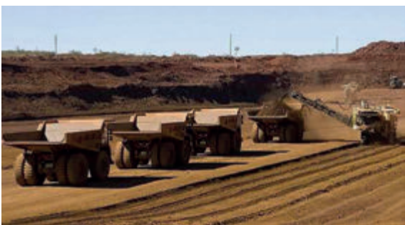
Rys. 3. Kombajn górnictwa powierzchniowego podający urobek na wozidło Fig. 3. Surface continuous miner loading onto off-highway truck
