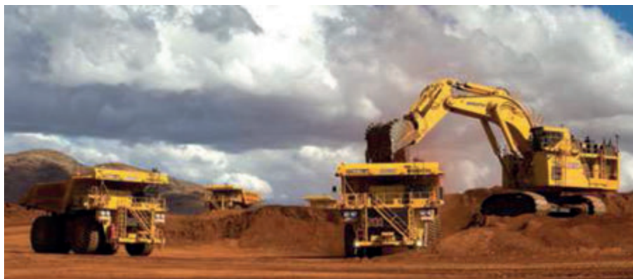
Rys. 7. Zdalnie sterowane wozidła pracujące w kopalniach zagłębia Pilbara, Australia (E&MJ) Fig. 7. Remotely controlled Komatsu off-highway trucks in Pilbara, Australia (E&MJ)
