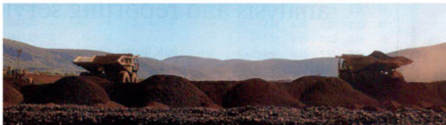
Rys. 9. Zdalnie sterowane wozidła firmy Caterpillar pracujące w kopalni Solomon ( E&MJ )
