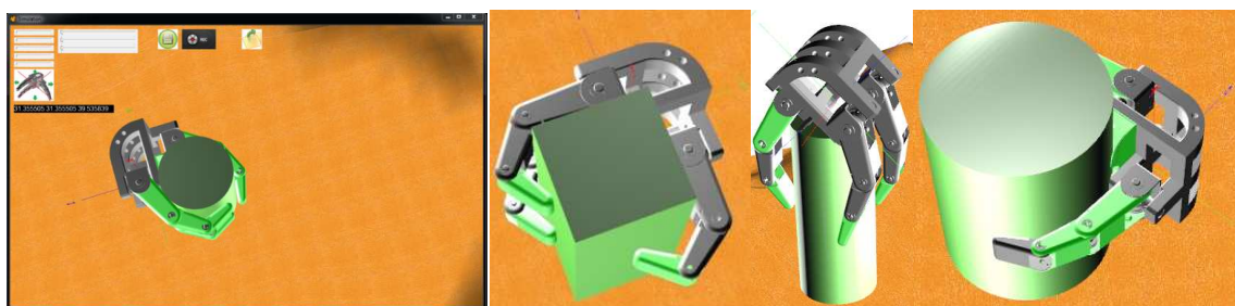
Rys. 10. Model wirtualny chwytaka robotycznego (po lewej) oraz przykłady testów chwytania różnych obiektów z zastosowaniem urządzenia CyberForce jako sposobu interakcji
