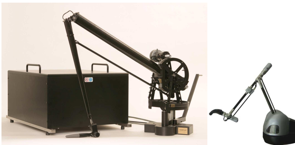
Rys. 5. Uniwersalne manipulatory haptyczne –Phantom Premium 3.0 (po lewej) i Haption Virtuose 6D 35-45 (po prawej) [7],[8]
