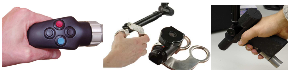
Rys. 4. Efektory urządzeń haptycznych – sztywny z przyciskami (po lewej), dwuczłonowy (na środku), własny wykonany technikami szybkiego wytwarzania (po prawej) [7],[8]
