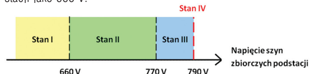
Rys. 4. Wartość napięcia szyn zbiorniczych podstacji przy różnych stanach pracy układu zasilania podczas hamowania odzyskowego
