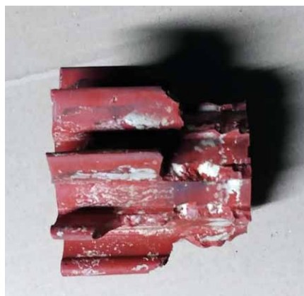
Rys. 3. Widok uszkodzonego silikonowego wirnika (Źródło: opracowanie własne)
