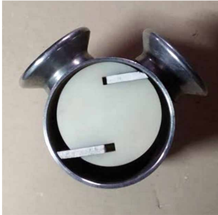
Rys. 7. Widok złożonej pompy od dołu
