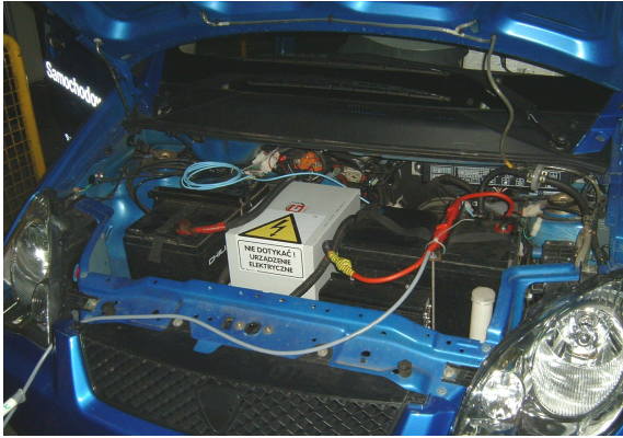
Rys. 2. Widok komory akumulatorów samochodu elektrycznego Zilent Courant
