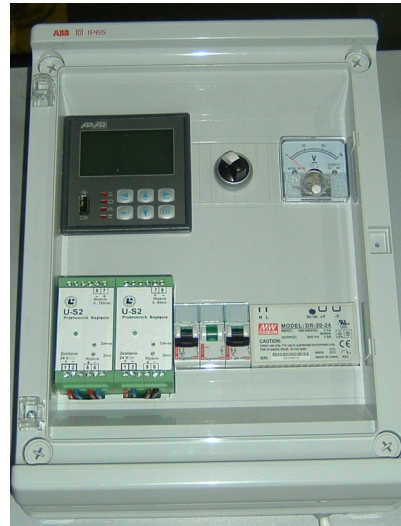
Rys. 3. Rejestrator procesu ładowania oraz przebiegu testu jezdnego
