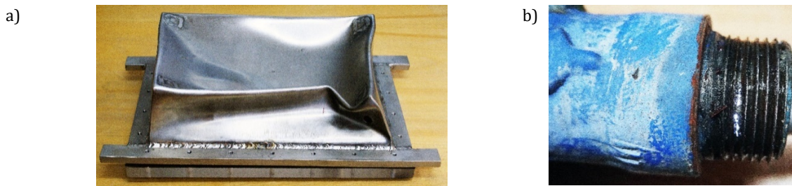
Rys. 12 Przykłady elementów wykorzystywanych w układach techniki nurkowej o wadliwej konstrukcji: a) pojemnik ciśnieniowy do komputera stanowiska badań wysiłkowych; b) część gwintowana zaworu bezpieczeństwa zamontowanego w gnieździe zbiornika rozchodowego powietrza.
