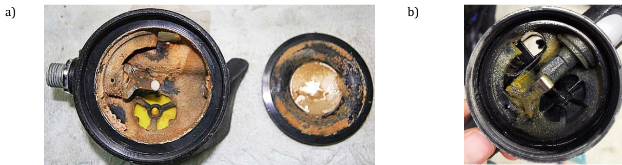
Rys. 5 Przykłady zanieczyszczenia II stopnia automatu oddechowego [8,12].
