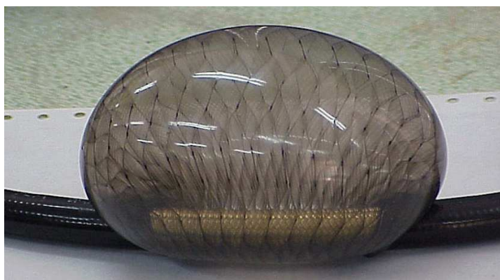
Rys. 14 Przypadek rozwarstwienia obłożenia wykonanego z tworzywa od metalowego oplotu ciśnieniowego, elastycznego węża instalacji nurkowej.
