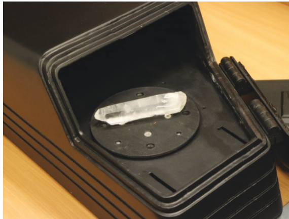
Fig. 3. 3D scanning of quartz crystal using SMARTTECH mini
