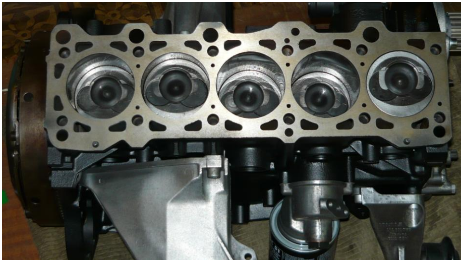
Rys. 3. Blok silnika po naprawie Fig.3. Block of the engine after repair
