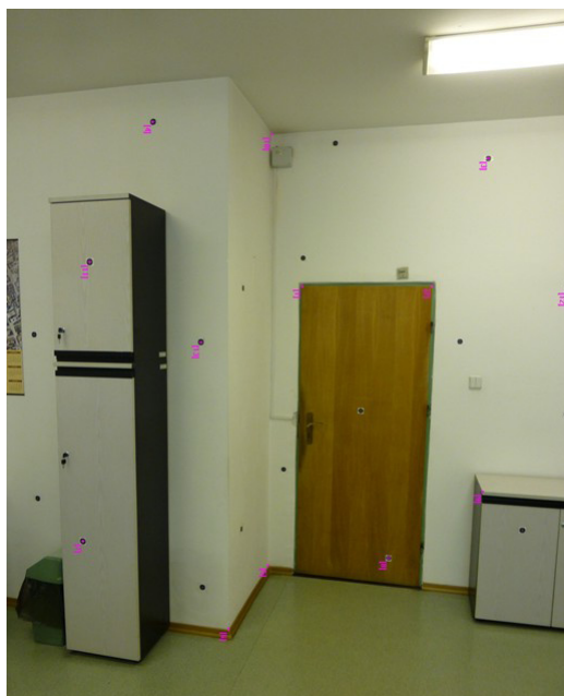
Rys. 1. Punkty homologiczne wykorzystane do powiązania danych rastrowych z aparatu kompaktowego Panasonic TZ30 z testowym zbiorem punktów 3D
