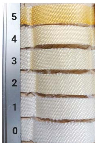
Figure 12. Change in appearance of inner lining of hose tape samples Rycina 12. Zmiana w wyglądzie wykładziny wewnętrznej próbek taśmy węzowej
