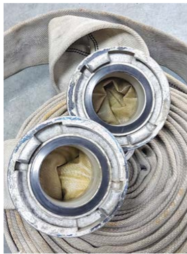
Figure 5. Firefighting hose in which there has been a loss of adhesion between the layers of hose tape Rycina 5. Pożarniczy wąż tłoczny, w którym nastąpiła utrata adhezji pomiędzy warstwami taśmy węzowej
