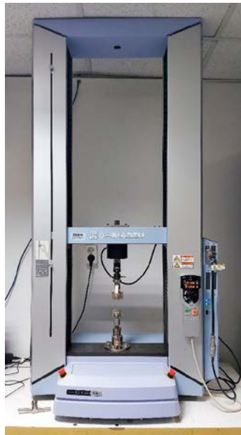
Figure 8. Shimadzu AG-X plus 10 KN testing machine with SLBL-500 N0 testing head Rycina 8. Maszyna wytrzymałościowa Shimadzu AG-X plus 10 KN z głowicą SLBL-500 N0 Source: Own elaboration. Źródło: Opracowanie własne.
