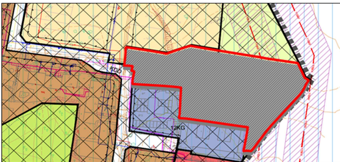
Rys. 14.2 Lokalizacja projektowanej inwestycji w MPZP (czerwona obwódka) z zaznaczoną informacją o zagrożeniu ze strony płytkich zrobów, na podstawie z oceny terenu na etapie likwidacji kopalni
