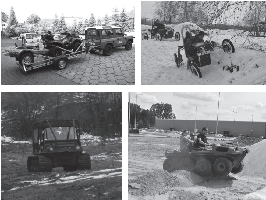
Rys. 7. Przykłady pojazdów lądowych przystosowanych do jazdy w trudnym terenie (u góry po lewej quad na przyczepce ciągnionej przez samochód Land Rover Defender 110, na górze po prawej wszędołaz Swincar, na dole amfibia ARGO 8×8 w wersji gaśnicowej i kołowej)
