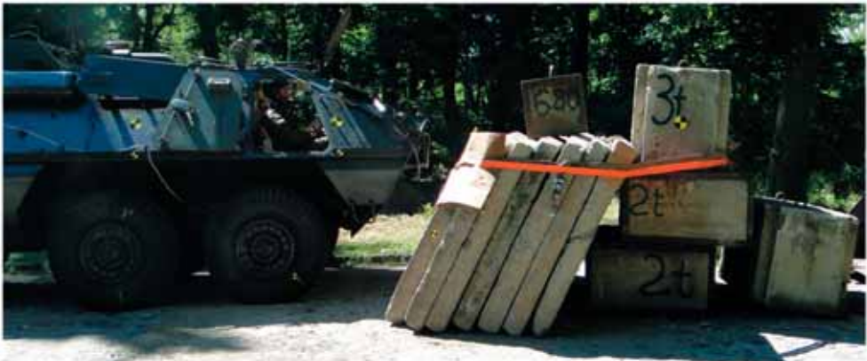
Rys. 5. Przeszkoda betonowa po zderzeniu z prędkością 12,10 km/h
