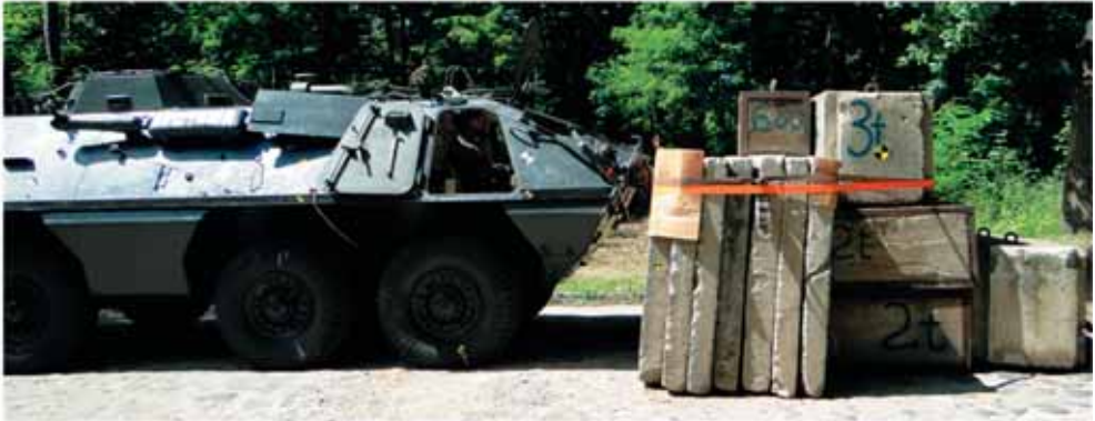
Rys. 1. Transporter SKOT i przeszkoda betonowa przed próbą
