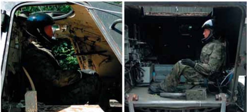
Rys. 2. Manekin badawczy w przedziale kierowanie (strona lewa) i w przedziale desantowym
