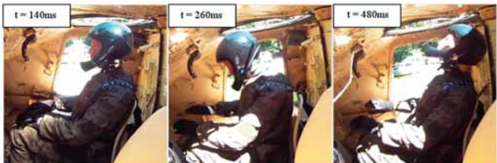
Rys. 7. Fazy ruchu manekina w przedziale kierowania podczas zderzenia (próba 5)
