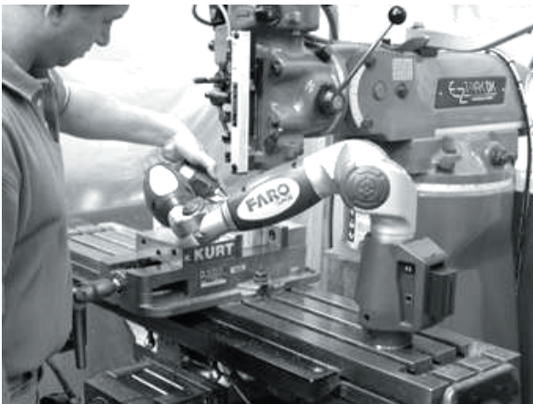
Rys.19. Przykład pomiaru elementu maszynowego bezpośrednio na obrabiarce Fig. 19. The example of a measurement directly on a machine tool
