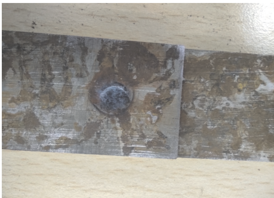
Rys. 9. Zgrzeina uzyskana dla próbki skorodowanej
