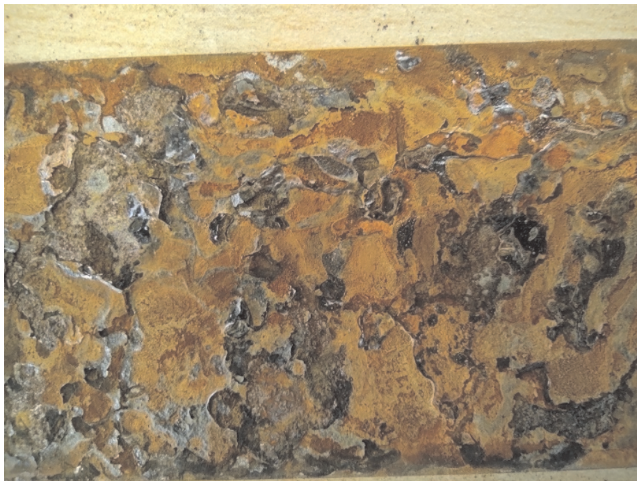
Rys. 4. Powiększenie powierzchni próbki w stanie skorodowanym
