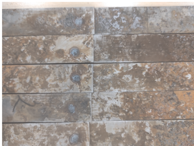
Rys. 8. Zgrzane próbki uzyskane z materiału z korozją
