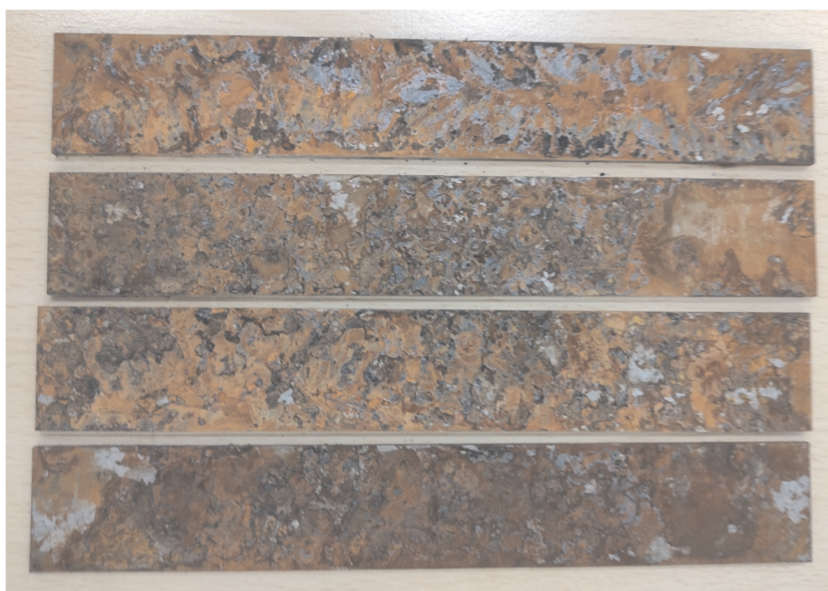
Rys. 3. Próbkę wykonane z blachy S235 w stanie skorodowanym
