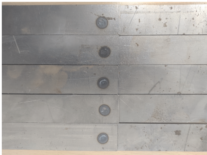
Rys. 7. Zgrzane próbki uzyskane z materiału bez korozji
