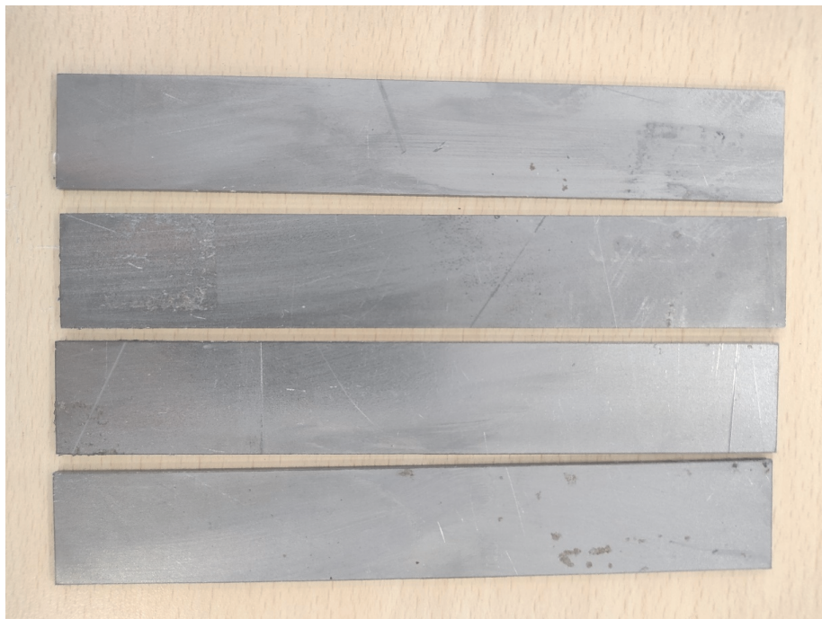
Rys. 2. Próbkę wykonane z blachy S235 w stanie nieskorodowanym
