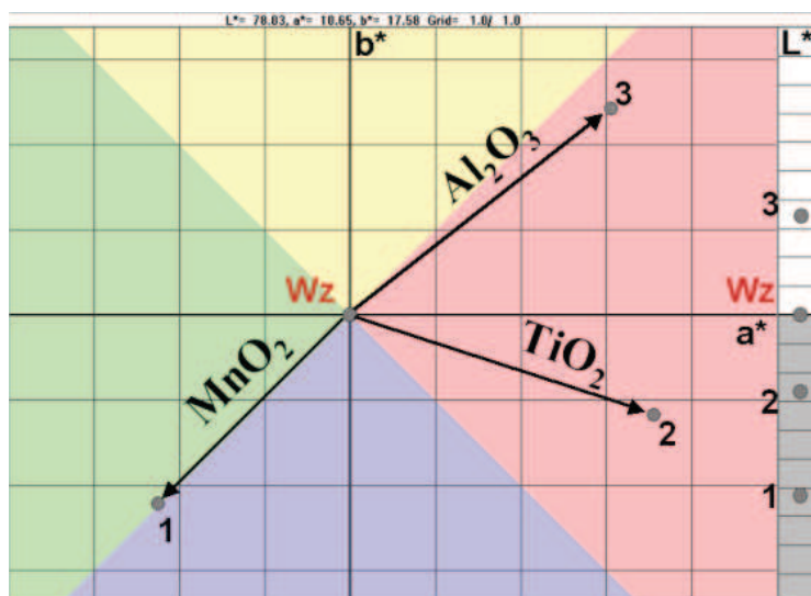
Ryc. 24. Tendencje zmiany barwy i intensywności różowego pigmentu cyrkonowo-żelazowego pod wpływem różnych dodatków tlenkowych w ilości 2% wag. [76]
