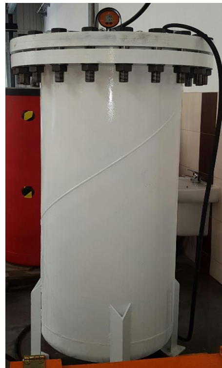
Rys.11. Komora ciśnieniowa w której badano skuter podwodny (źródło własne)
