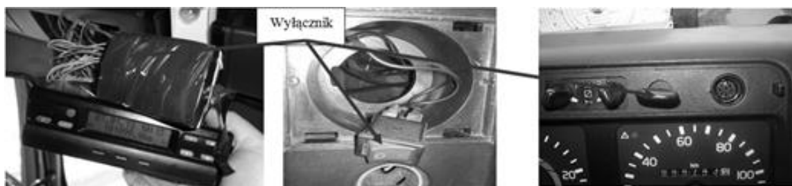
Rys. 2.6 Rodzaje wyłączników tachografów analogowych
