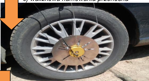
d) zamontowana na koło hamownia drogowa
