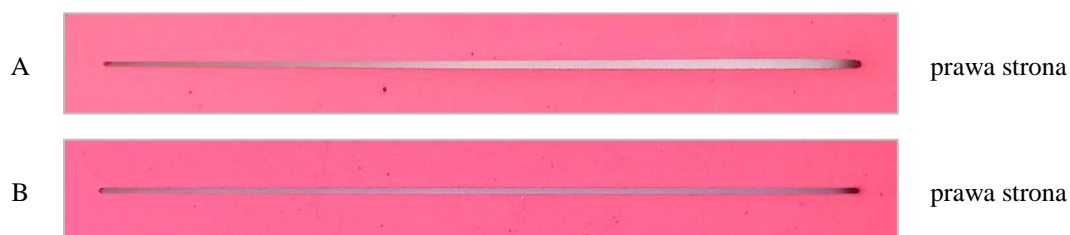
Rys. 6. Zobrazowanie efektu cięcia materiału – tworzywa „EVA” (prawej strony) przy kontrastowym ustawieniu parametrów prędkości i mocy, tj. A: 50 mm/s i 100% oraz B: 100 mm/s i 50%, [źródło: opracowanie własne].
