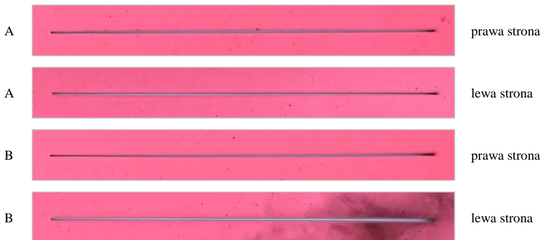
Rys. 5. Zobrazowanie efektu cięcia materiału – tworzywa „EVA” przy pozycji ustawienia wiązki lasera: nieostrego (A) i ostrego (B) – na powierzchni materiału, [źródło: opracowanie własne].
