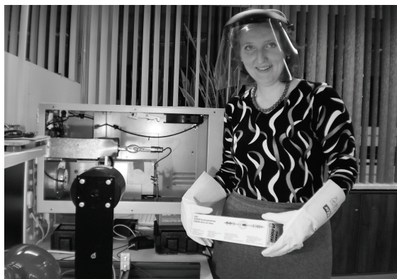
Rys. 2. Lampa ksenonowa w specjalnie przeznaczonej do badań oprawie oświetleniowej oraz specjalne środki ochrony w postaci maski i rękawic ochronnych
