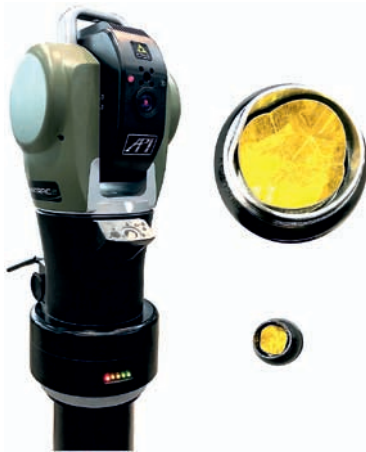
Rys. 2. Traker laserowy Omnitrac 2 firmy Automated Precision wyposażony w moduł komunikacji bezprzewodowej. Dodatkowo zaprezentowano dwa retroreflektory o średnicach 1,5 cala oraz 0,5 cala, które z wykorzystaniem odpowiednich adapterów, mogą służyć do pomiarów płaszczyzn (adapter „flat nest”) i otworów (adapter „pin nest”).
