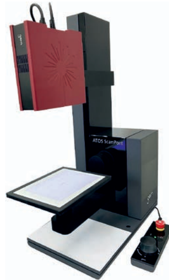
Rys. 3. GOM ATOS ScanPort - skaner wykorzystujący światło strukturalne wyposażony jest w zautomatyzowany stolik obrotowy; widoczna płyta kalibracyjna zamontowana w miejscu stolika.
