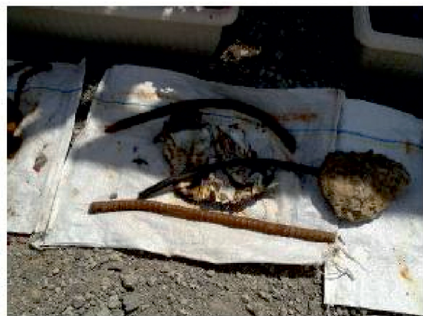
Fot. 14. Pręty stalowe wydobyte podczas budowy tunelu [5]
