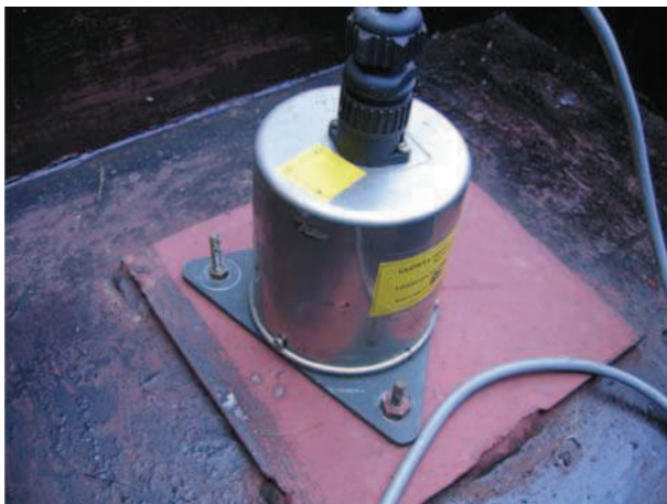
Rys. 2. Czujnik pomiarowy systemu AMAX-99 Fig. 2. Sensor of AMAX-99 system
