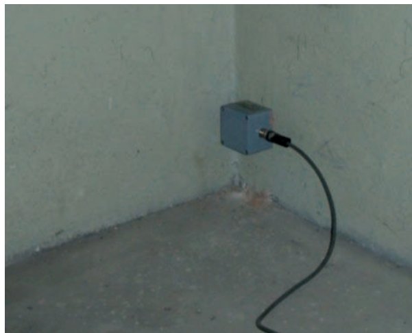
Rys. 4. Czujnik rejestratora AMAX-GSI Fig. 4. Sensor of AMAX-GSI system
