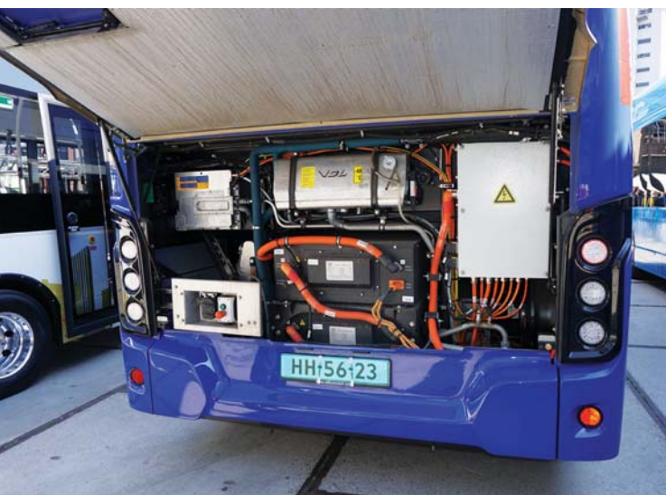
Elektryczna Citea o długości 12 m zbudowana na zamówienie globalnego przewoźnika Arriva – z lewej wewnątrz komory silnikowej VDL Citea electric
