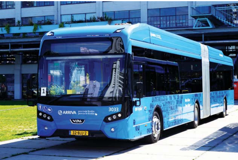
Elektryczny autobus przegubowy o długości 18,75 m, zakupiony przez firmę Arriva do obsługi systemu komunikacyjnego na Wyspach Fryzyjskich
