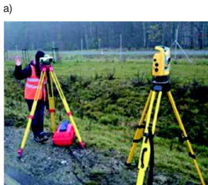
Fot. 2. Sprzęt do niwelacji precyzyjnej a) niwelator cyfrowy Leica DNA03 oraz tachimetr zmotoryzowany Trimble S3, b) stopka łaty inwarowej na punkcie pomiarowym
