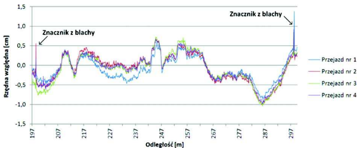
Rys. 7a. Profile nawierzchni pobocza na odcinku o długości 100 m z widocznymi zaburzeniami wartości względnych rzędnych wynikających z obecności znaczników z blachy
