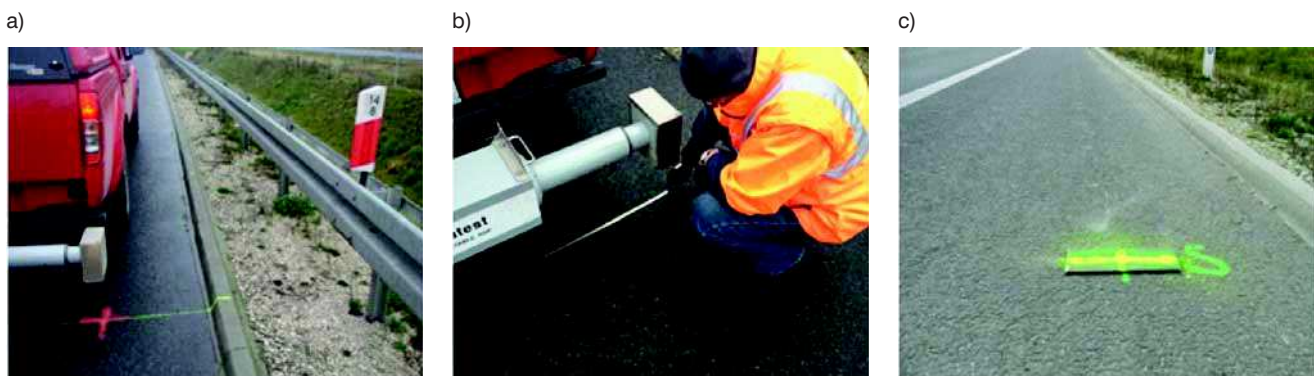
Fot. 1. Ilustracja: a) początek odcinka „rozpędu” urządzeń pomiarowych do stałej prędkości równej 50 km/h, b) początek odcinka pomiarowego, c) lokalizacja znacznika z blachy
