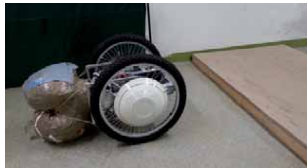
Rys. 7. Stanowisko badawcze dla manewru pokonywania progu Fig. 7. Test environment for passing a step maneuver
