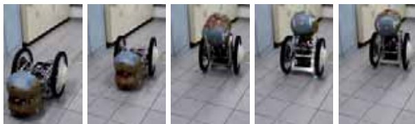
Rys. 15. Położenie robota podczas automatycznego wstawiania do pionu w chwilach 1,3 s, 2,0 s, 2,8 s, 3,2 s, 4,0 s
