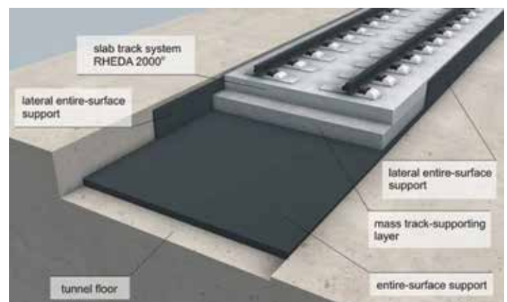
Rys. 6. Rheda 2000® z wibroizolacją [8]
