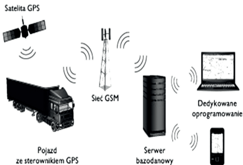
Rys. 2. Schemat działania satelitarnego śledzenia pojazdu
