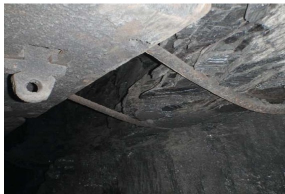
Rys. 4. Żerdziowanie (prętowanie) Fig. 4. Poling
