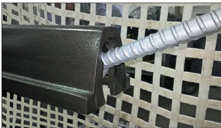
Rys. 7. Stropnica przyczółowa Fig. 7. Mining roof at the front
