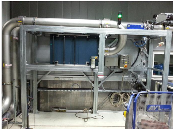
Zdjęcie 2. Laboratorium Badania Emisji Spalin w Instytucie Badań i Rozwoju Motoryzacji BOSMAL – tunel rozcieńczający spaliny [3]
