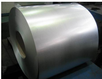
Rys. 2. Zwoje blachy cienkiej ze stali węglowej gorącowalcowane
