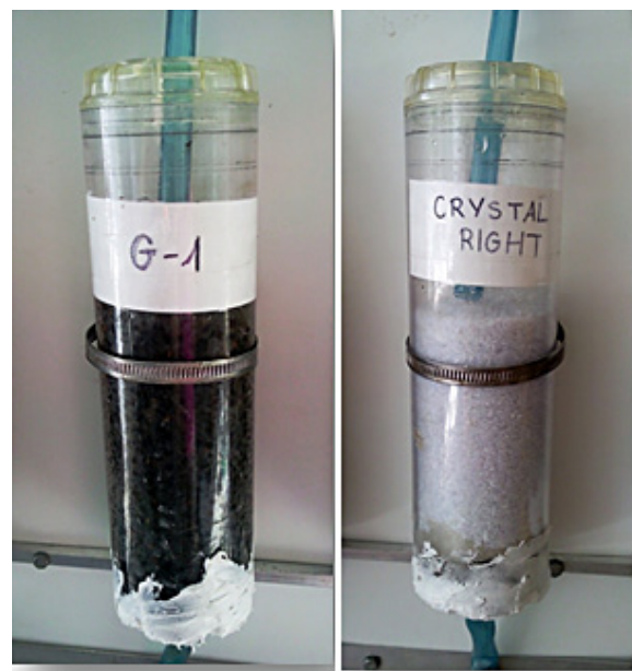
Rys. 3. Kolumny filtracyjne Fig. 3. Filter columns
