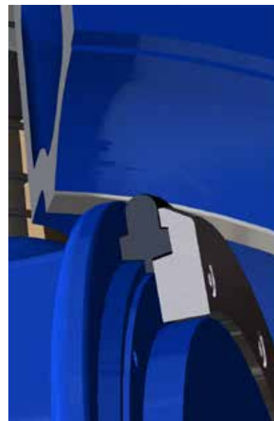
Rys. 5. Pierścienia dociskowy w przepustnicy podwójnie mimośrodowej COR2010
