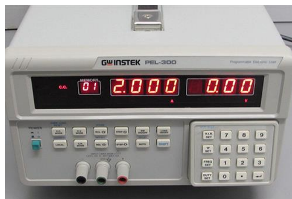
Rys. 8. Obciążenie elektroniczne GW Instek PEL-300
