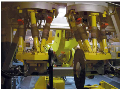
Rys. 11. Roboty F-200iB firmy FANUC na stanowisku do cięcia detali
