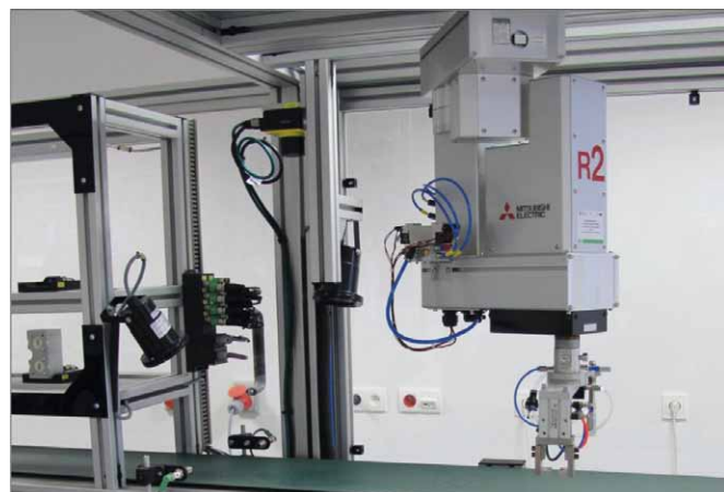
Rys. 14. Robot SCARA RH-3FHR firmy Mitsubishi na stanowisku roboczym
