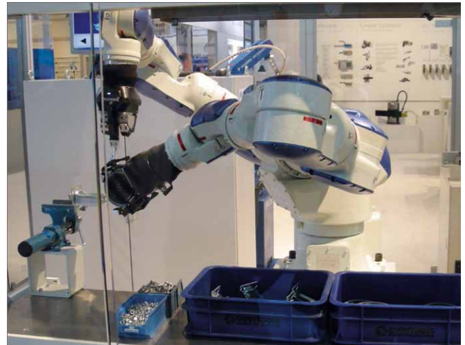
Rys. 17. Robot SDA20D firmy Motoman na stanowisku obróbczym
