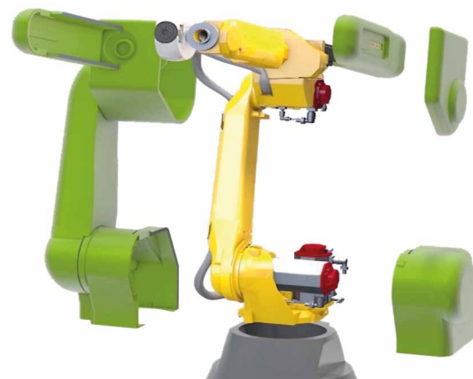
Rys. 25. Konstrukcja robota kolaboracyjnego CR-35iA firmy FANUC
