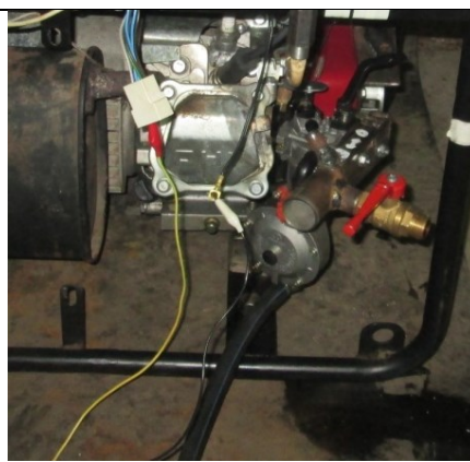
Рисунок 2. Общий вид многотопливного карбюратора 168F-СУГ и смесителя для генераторного газа
