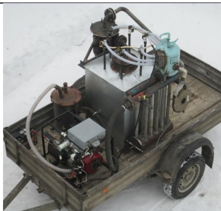
Рисунок 5. Общий вид экспериментальной газогенераторной установки с электростанцией GG - 2700
