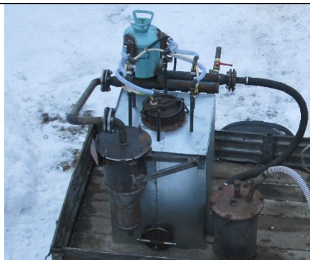
Рисунок 4. Общий вид экспериментальной газогенераторной установки
