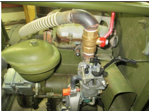
Рисунок 3. Общий вид системы зажигания, многопливного карбюратора 188F-CUG и смесителя для генераторного газа
