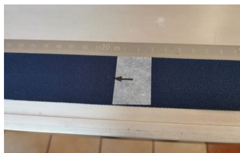
Rys. 4. Stanowisko do oceny zgodności przyrządów do pomiaru długości w Wydziale Zamiejskowym w Brodnicy Okręgowego Urzędu Miar w Bydgoszczy
