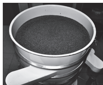
Rys. 3. Górny pokład sitowy wraz z nasionami [źródło własne]
