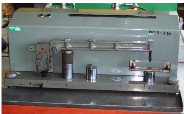
Rys. 7. Aparatura do oznaczenia wytrzymałości na ściskanie mas formierskich
