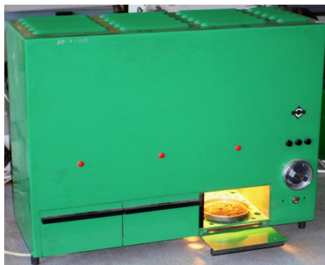
Rys. 2. Suszarka pośpieszna trójstanowiskowa typu LAPS
