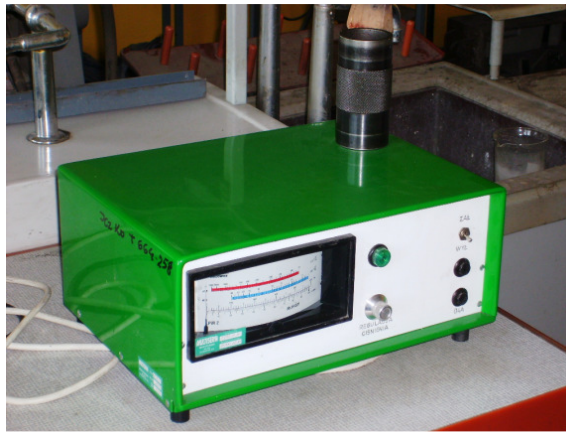
Rys. 6. Aparat elektryczny typu LPiR do oznaczenia przepuszczalności
