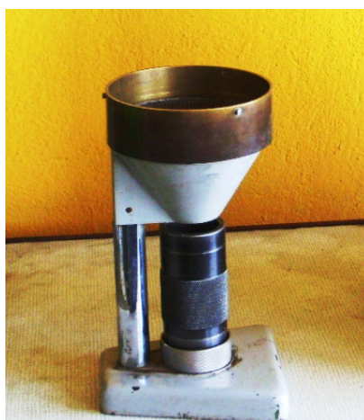
Rys. 5. Przystawka do przesiewania masy do badania zagęszczalności
