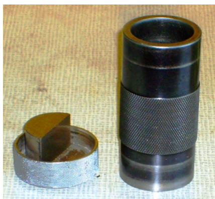
Rys. 4. Tuleja i podstawka do pomiaru płynności metodą Orłowa
