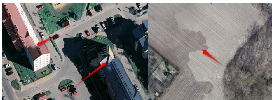
Rys. 4. Obraz po lewej stronie przedstawia ortofotomapę z niepoprawnie przeprowadzonym procesem mozaikowania ortobrazów (w wyniku błędnie poprowadzonej linii mozaikowania). Obraz z prawej strony przedstawia nieprawidłowy przebieg linii mozaikowania na ortofotomapie
