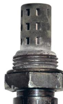
Rys. 3. Sonda lambda nieuszkodzona.
