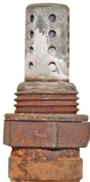
Rys. 4. Sonda lambda zanieczyszczona środkiem niezamarzającym.
