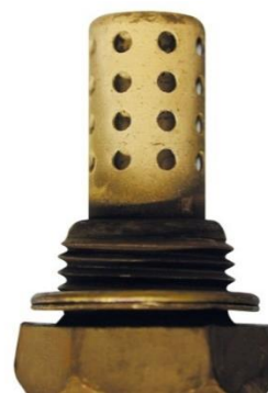
Rys. 6. Sonda lambda zanieczyszczona dodatkami.
