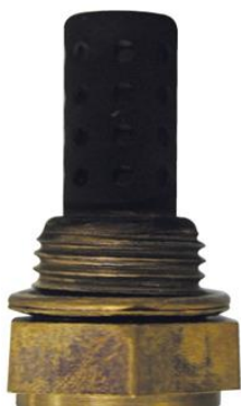
Rys. 5. Sonda lambda zanieczyszczona olejem.
