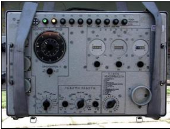
Rys. 16. Widok przyrządu kontrolnego PNK-3M w czasie pomiaru błędów kardanowego systemu nawigacji inercyjnej IKW-8 [14]
