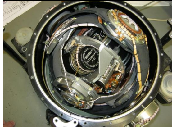
Rys. 12. Budowa wewnętrzna bloku KW-1 kardanowego systemu nawigacji inercjalnej IKW-8 z giroskopami mechanicznymi [14]
