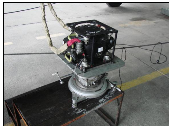
Rys. 2. Widok bloku pomiarowego kardanowego KW-1 systemu nawigacji inercyjnej IKW-8 na stole przechylnym KPA-5 [14]
