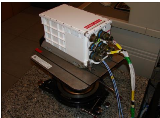
Rys. 4. Widok bloku pomiarowego bezkardanowego systemu nawigacji inercyjnej EGI-3000 na stole przechylnym KPA-5 [9]
