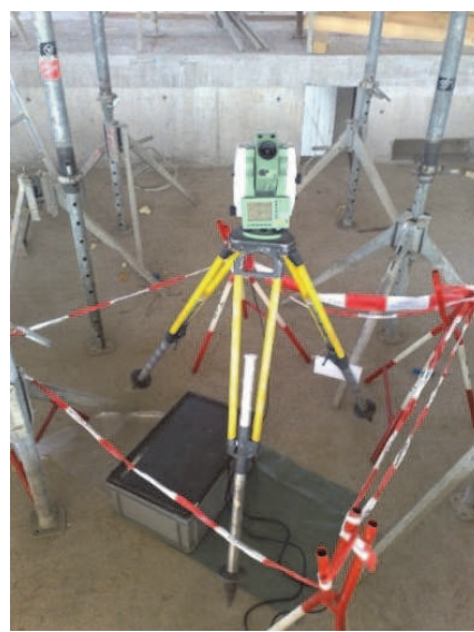
Rys. 6. Widok tachimetru Leica TCRP1201 plus na stanowisku pomiarowym – fot. autor
